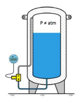
válvulas acopladas, como el nivel del líquido. Con el transmisor KELLER PRD-33X, es posible medir la presión v el nivel simultáneamente.
